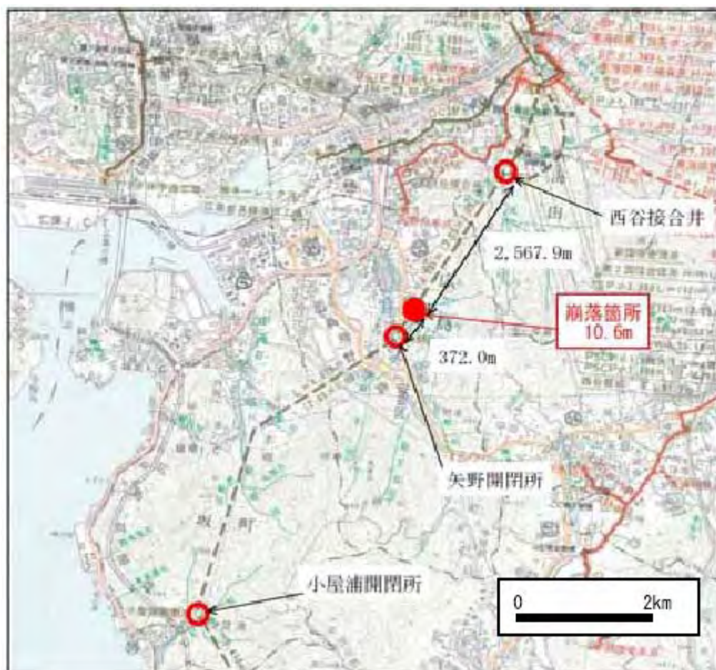
図 2.2 送水トンネル崩落箇所
