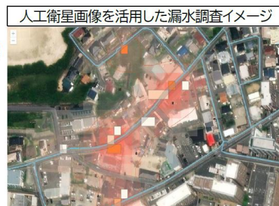
人工衛星画像を活用した漏水調査イメージ ※漏水リスクエリアを赤色で表示
