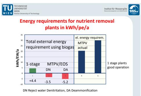
Δ Energie DA versus DN for 3 Mio pe : 5,2 – 3,5 =1,7; 1,7 ∗ 3 = 5 Mio kWh/a (~ 500.000 €/a)
