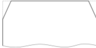
図 A.4—熱収縮シート貼り始め部両端の切り除き
